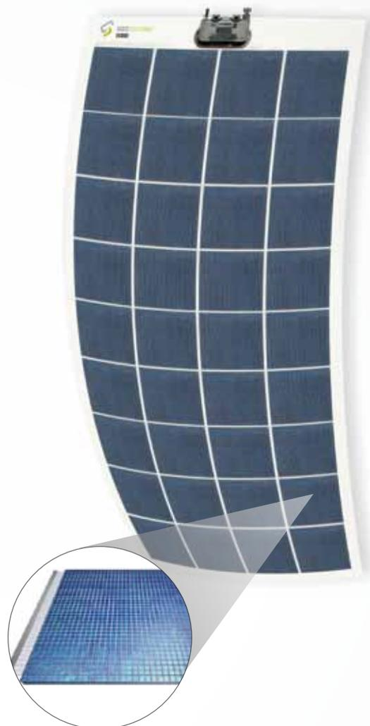
La Gicosolutions ha sviluppato e brevettato l'ultima generazione di pannelli fotovoltaici flessibili realizzati con l'innovativa tecnologia DAY4, prodotti con particolari tecnopolimeri che gli permettono di avere un peso di circa 1/8 rispetto ai classici pannelli in vetro.
