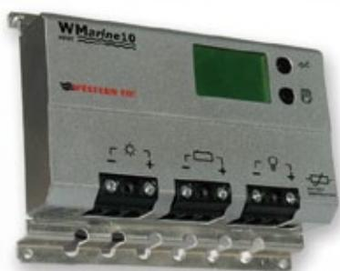
Il W Marine 10 è un regolatore di carica con tecnologia "MPPT buck-boost" in grado di pilotare i pannelli con tensione nominale superiore o inferiore a quella della batteria ottimizzandone la carica. Una tecnologia che rende facile ogni tipo di installazione nelle applicazioni nautiche.
